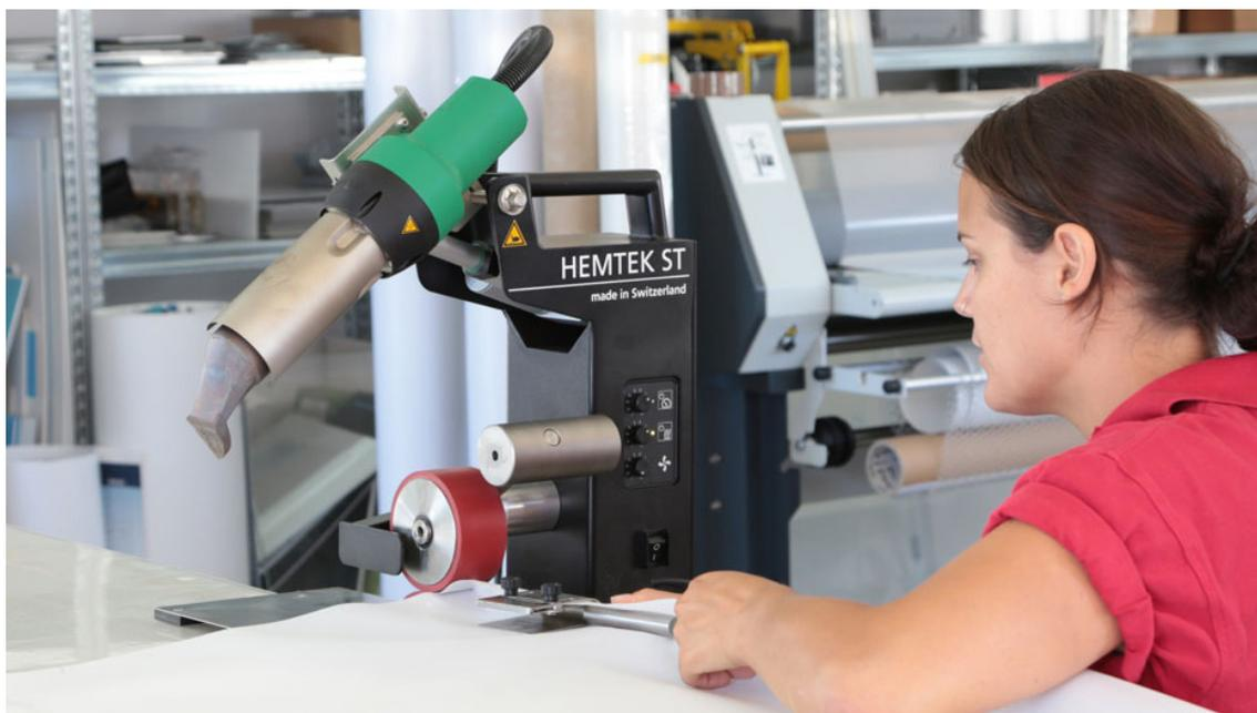
En acción la nueva máquina de soldadura para dobladillos HEMTEK
